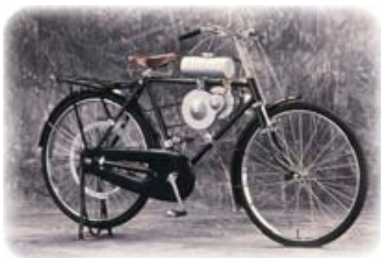
1946年 無線機用発電機を改造し自転車に装着
