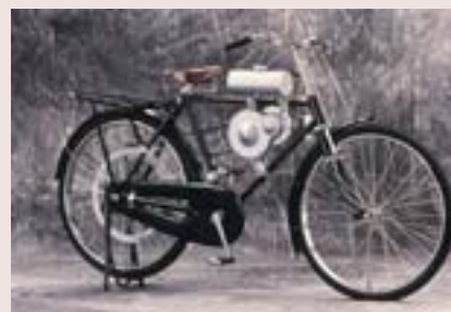
1946年 無線機用発電機を改造し自転車に装着
